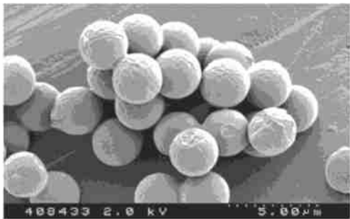
图 7 以全氟聚醚为表面活性剂时 PMMA 粒子的电镜照片
